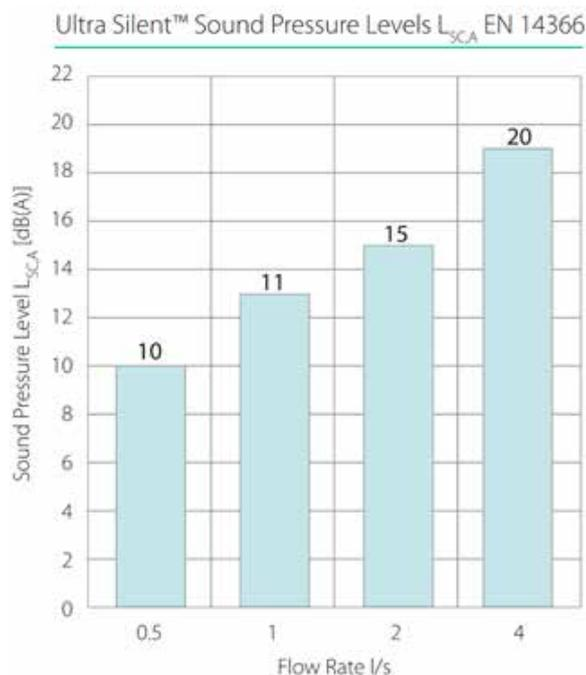
Lyddiagram fra Fraunhofer testrapport P-BA 20/2019e, iht. EN 14366.
